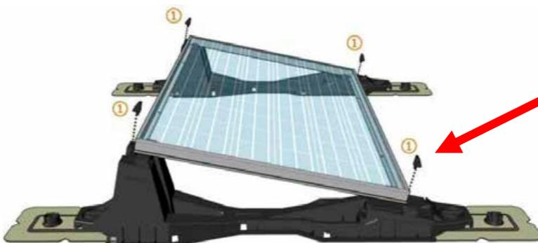
6) Je 4 Sicherheitsstifte pro Modul in die Hauptstrukturen einsetzen. Abstand zum Modulrahmen möglichst gering, aber **mind. 2mm!**
