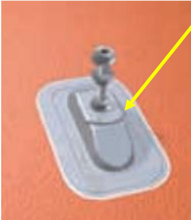
8) Schraube mit Abdeckkappe ansetzen und festziehen, bis die Neoprendichtung **vollflächig** zwischen Sunny und Abdeckklappe geklemmt ist
