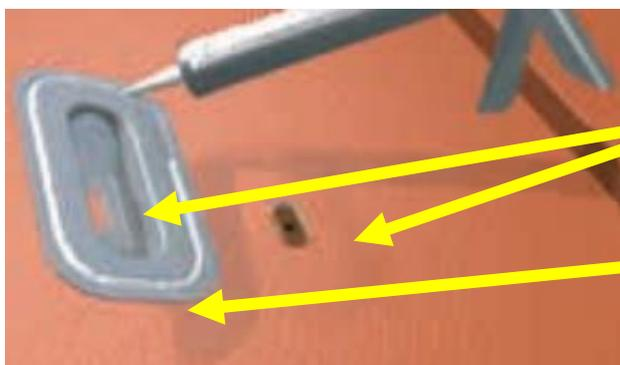
6) Klebestellen mit Haftreiniger reinigen
