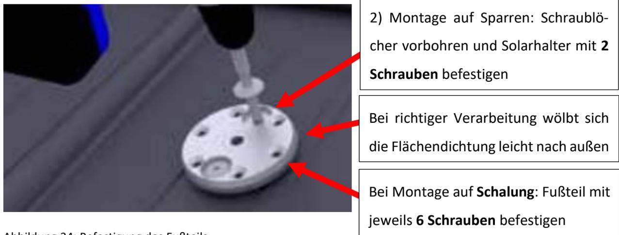
Abbildung 34: Befestigung des Fußteils
