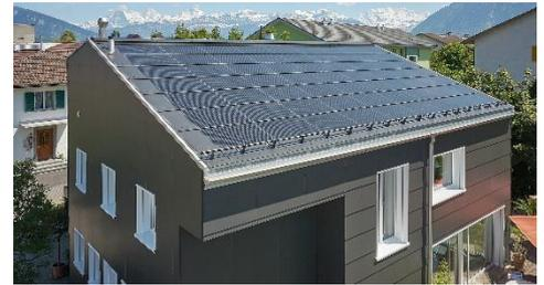
Abbildung 80: Solardachziegel
