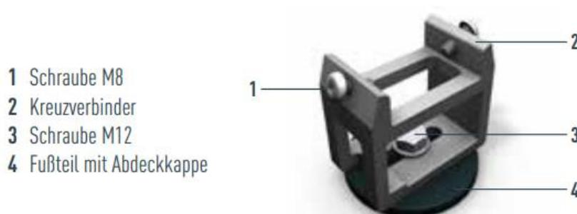
Abbildung 32: Solarhalter Fix (Quelle: Prefa Verlegerichtlinien Solarmontagesystem Version 06/2021)
